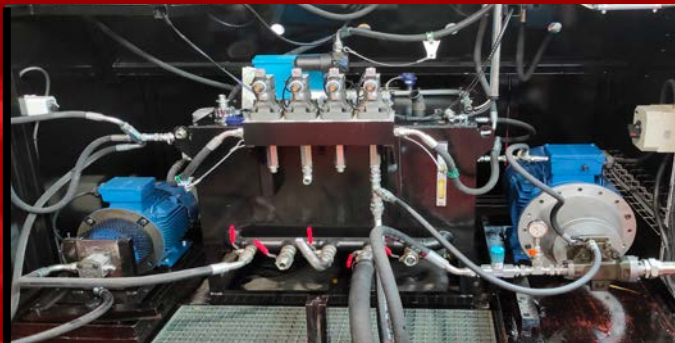
BANCO PARA PRUEBAS DE BOMBAS HIDRÁULICAS HYDRAULIC PUMPS ASSEMBLY
