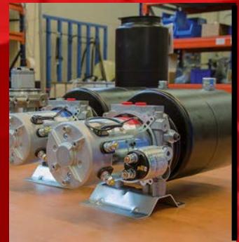
MONTAJE DE MINICENTRAL POWERPACK ASSEMBLY
